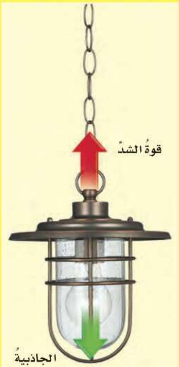
القوى المؤثرة في المصباح متزنة وتمنعه من السقوط.
